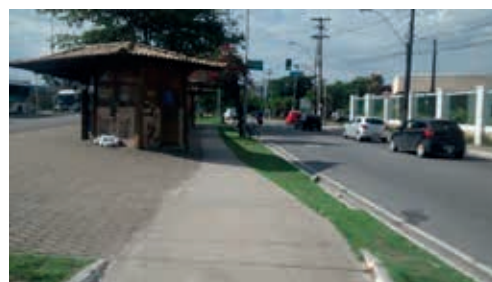
Ciclovía se junta com ponto de transporte público e se conecta com travessia de pedestres sem nenhuma preparação ou canalização, nem mesmo sinalização.
